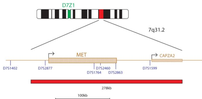
A C-MET Amplification Probe consiste numa sonda vermelha de 278 kb que abrange o gene C-MET (MET). A sonda centromérica verde atua como controlo para o cromossoma 7.
