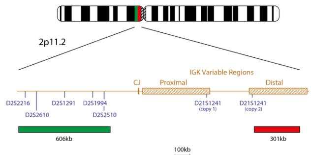
O produto de *IGK* consiste numa sonda de 301 kb, marcada a vermelho, que abrange parte da região Variável distal do *IGK*, e numa sonda verde, que abrange uma região de 606 kb telomérica aos segmentos de Junção e segmento Constante do *IGK*. A sonda verde estende-se a partir de uma posição telomérica ao marcador D2S2216 e continua até uma posição centromérica ao marcador D2S2510.
