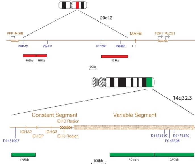
Produsul IGH/MAFB conține sonde, marcate cu verde, care se atașează de segmentele constant și variabil ale genei *IGH*, și sonde pentru gena *MAFB* (195 kb, 161 kb și 401 kb), marcate cu roșu. Sondele *MAFB* sunt localizate pe ambele părți ale regiunii punctelor de ruptură (între *MAFB* și *PPP1R16B*).
